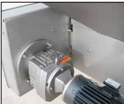
Se muestra la velocidad variable proporcionada por el motor controlado por inversor (opcional) o la caja de engranajes ajustable por volante.
