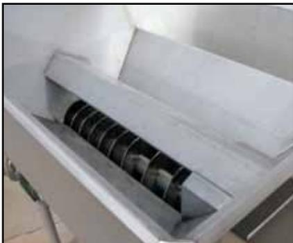
El amortiguador de soporte y el transportador de tornillo sinfín diseñado especialmente aseguran una descarga completa de la tolva sin dañar al producto.
