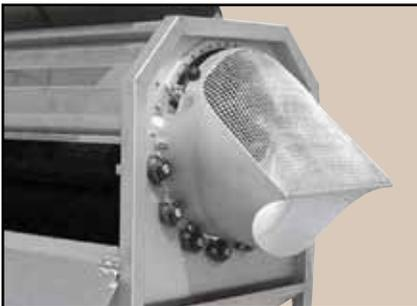
Los operadores pueden ajustar fácilmente la compuerta de descarga manual EasyFlow™ mientras observan el producto dentro de la máquina.
