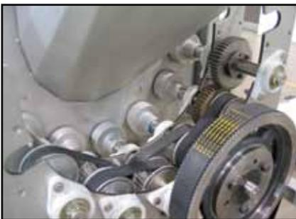
Vista de la caja de engranajes que muestra la calidad de diseño y construcción. Observe el "rodillo inversor" (arriba a la derecha) usado para aplicaciones específicas.
