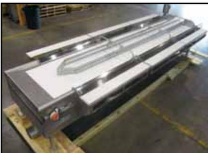
Modelo 3615 con transportadora de banda plana con divisor. La descarga se realiza a través de la sección central de la banda entre el divisor.
